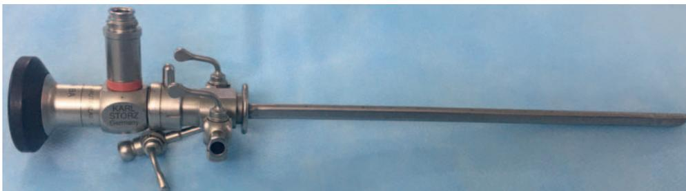
Рис. 8. Тубус с рабочим каналом, в который вводится многоцелевая жесткая оптика KARL STORZ
